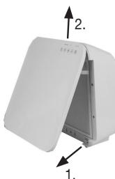
2. Zdjąć pokrywę obudowy jak przedstawiono na rysunku (zamknięcie magnetyczne). Wypiąć zamknięcie magnetyczne najpierw na dole, a następnie na górze.
