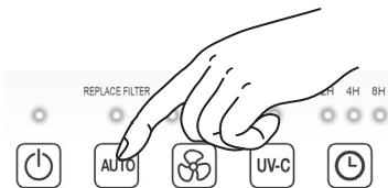
6. Conecte el conector de red a la toma de corriente. Coloque el cable de forma que no se pueda tropezar con él. Mantenga pulsado el botón AUTO (AUTO) durante 5 segundos. El contador de horas de funcionamiento se ha vuelto a reponer a 0.
